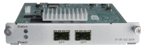
P-IP-02-SFP 千兆IP复用处理模块(光口)
