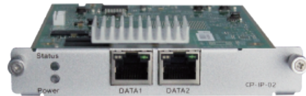
P-IP-02 千兆IP复用处理模块(电口)
