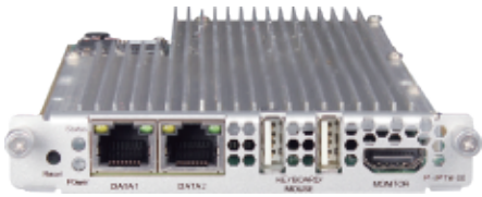
CP2-IPTV-00 模块化IPTV系统(面向安卓机顶盒集中管理)
